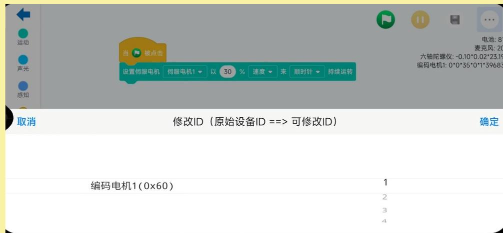
当修改（如：伺服电机）编号时，只能连接1个设备（伺服电机），不能同时连接两个相同的设备（伺服电机）。
