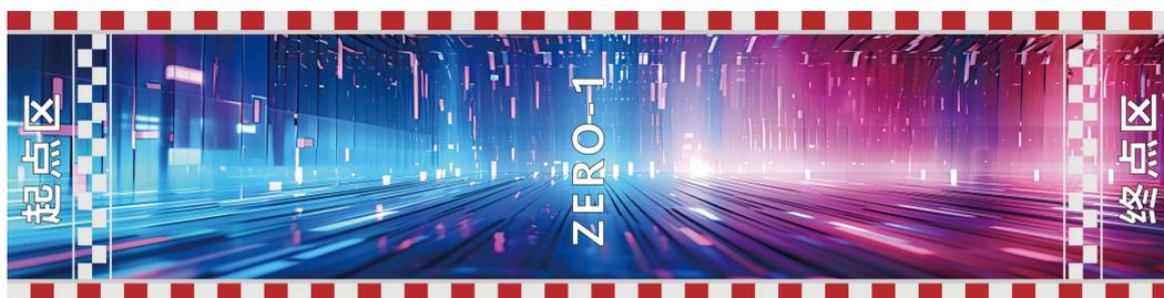
场地大小为400cm×100cm（示意图中的尺寸供练习时参考，竞赛场地的实际尺寸与示意图给定尺寸基本相同，允许有1cm范围制作误差）。场地如图所示，边框的宽度为1cm。实际比赛地图以现场公布为准。
